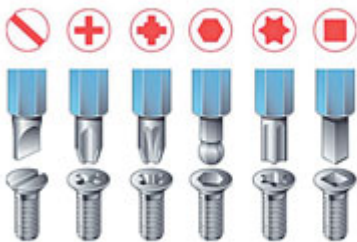
Мал. 247. Змінні наконечники для викрутки (а) та набір плоских і хрестоподібних викруток (б)
