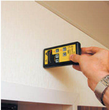
Мал. 243. Відшукування місць розташування схованої електропроводки
