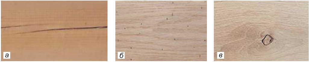
Мал. 140. Місця для шліфування: а – тріщини; б – червоточини; в – місця біля сучків
