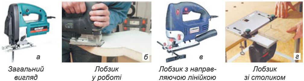
Мал. 173. Електричний столярний лобзик та робота ним
