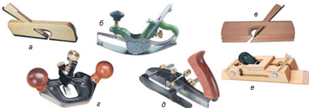
Мал. 80. Ручний інструмент для профільного стругання: а – зензубель; б – горбач із опуклим корпусом; в – фальцгебель; г – ґрунтубель; д – шпунтубель; е – фасонний рубанок
