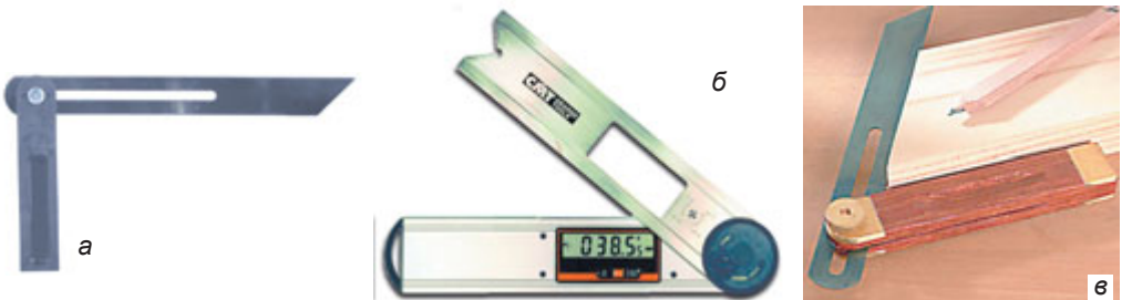
Мал. 51. Малка: а – загальний вигляд; б – сучасна малка з електронним кутоміром; в – прийом використання малки
