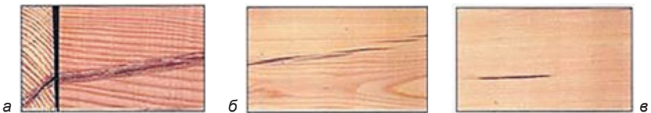
Мал. 28. Тріщини: а – морозяна тріщина; б – тріщина від усушки; в – смоляна кишенька
