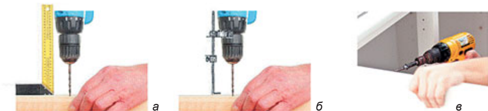
Мал. 130. Свердління електродрилем: а – контроль перпендикулярності свердління; б – свердління отвору з обмежувачем; в – загвинчування шурупів
