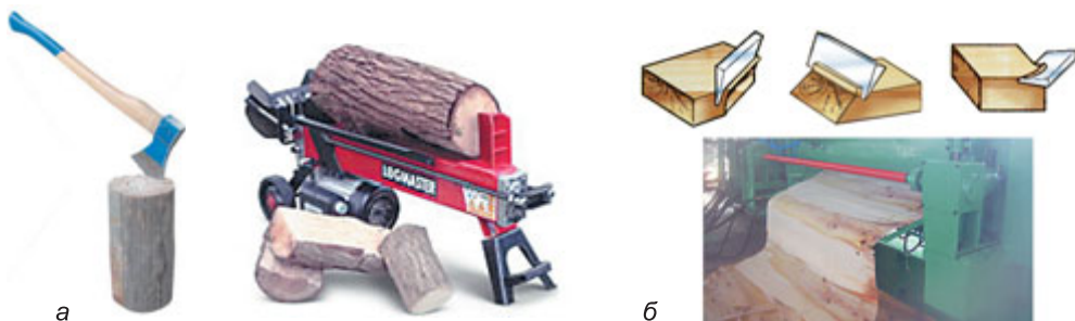
Мал. 57. Різання деревини без зняття стружки: а – розколювання деревини; б – розрізання на шпон
