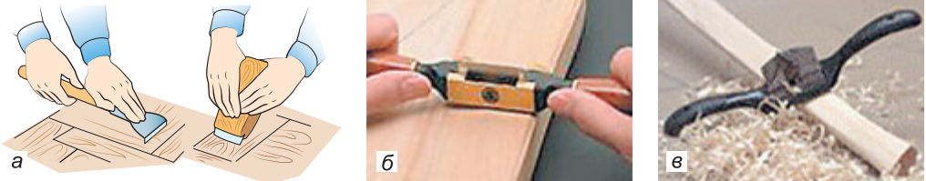
Мал. 84. Прийоми роботи ручними циклями: а – паркетною; б – площинною; в – фігурною
