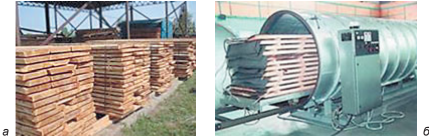
Мал. 26. Сушіння деревини: а – природним способом; б – в електросушарці
