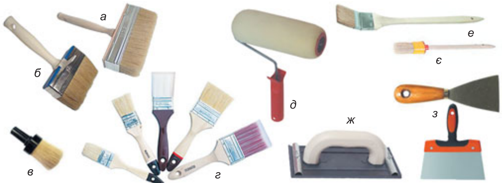
Мал. 211. Малярні інструменти: а – макловиця; б – щітка ракля; в – махова щітка; г – флейцові щітки (пензлі); д – валик; е – радіаторна щітка; є – фільонкова щітка; ж – терка шліфувальна; з – шпатель
