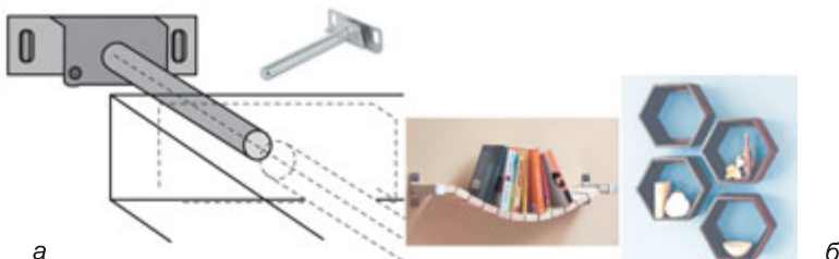
Мал. 242. Кріплення полиці на кронштейнах за допомогою штирів: а – схема кріплення; б – закріплені полиці
