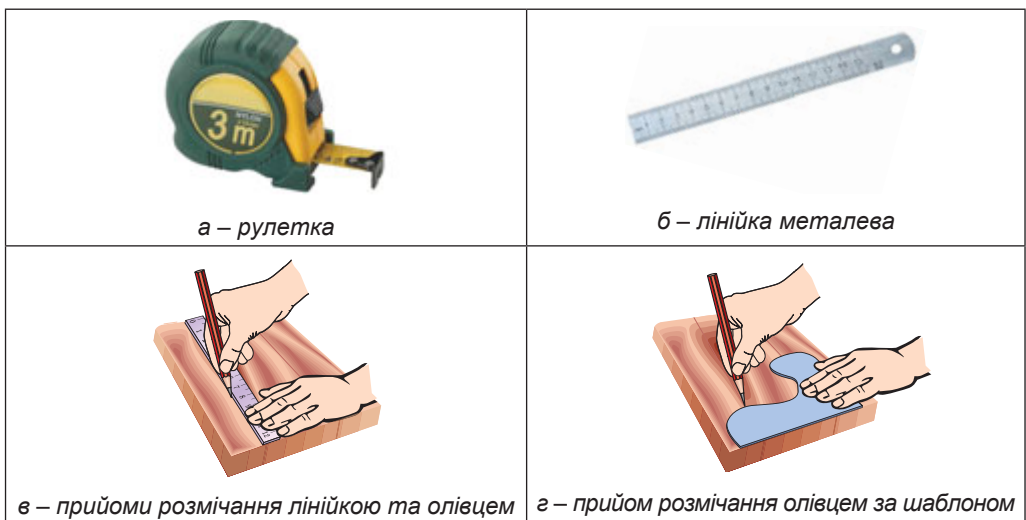
Мал. 47. Деякі розмічальні та вимірювальні інструменти (а, б), прийоми роботи (в, г)
