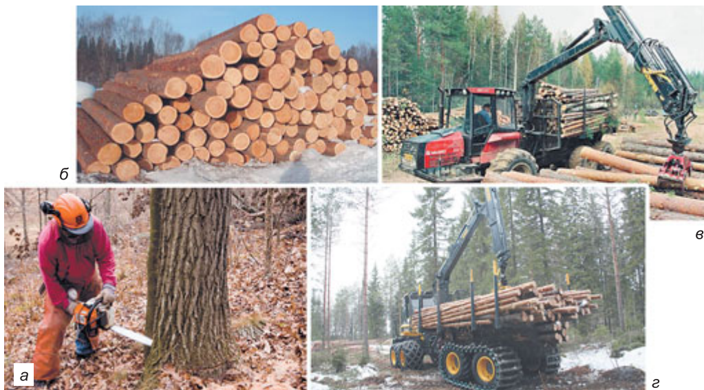
Мал. 9. Заготівка деревини: а – спилювання; б – накопичення хлестів; в – трелювання; г – транспортування
