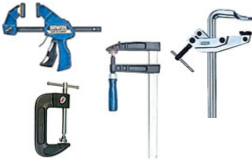
Мал. 117. Струбцини різних конструкцій
