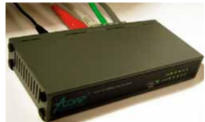
Рис. 2.3. Коммутатор для кабельных сетей
