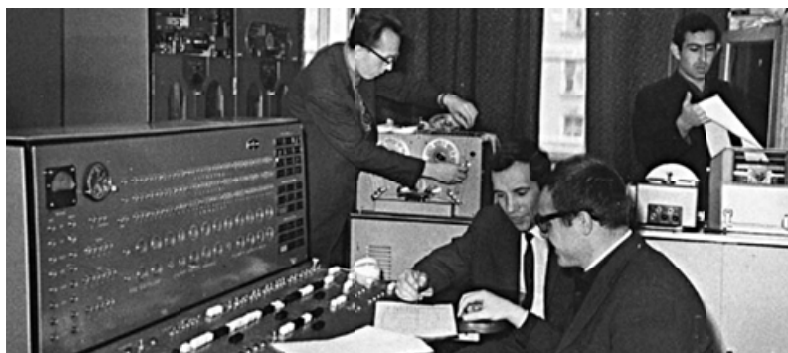
Рис. 1.7. Пульт управления ЭВМ «Минск» с разными системами ввода и вывода данных
