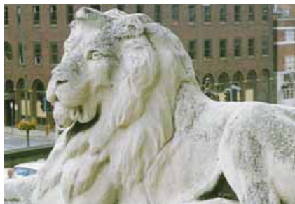
Рис. 29.7. Руйнування мармурової скульптури під впливом кислотних дощів
