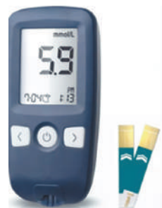
Мал. 3.1. А. Глюкометр: прилад для вимірювання вмісту глюкози у крові та тест-смужки до нього
