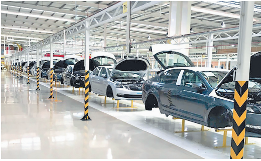
Мал. 86. Поточна лінія зі збирання автосерії Skoda Octavia на заводі «Єврокар» у с. Соломоново (Закарпатська обл.)
