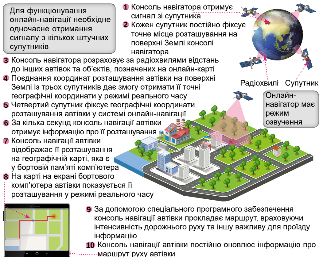
Мал. 10.3. Схема функціонування онлайн-навігатора автомобілів
