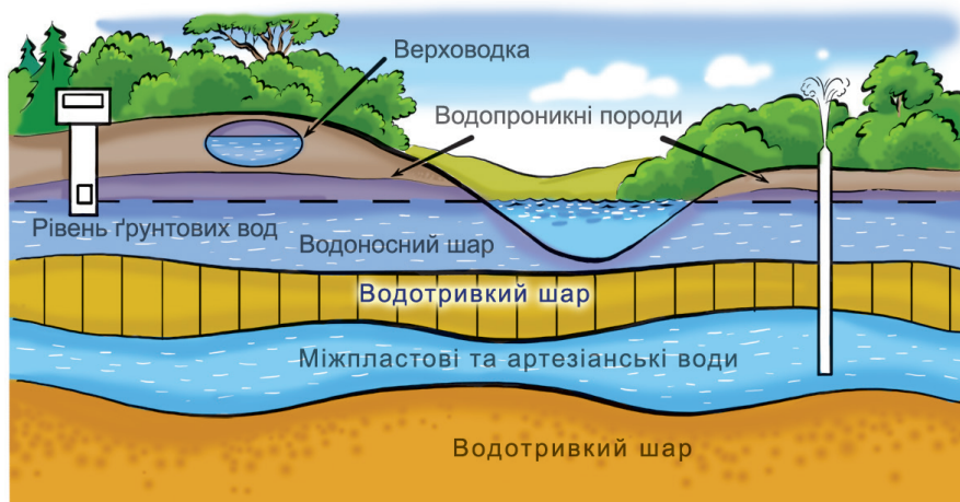
Мал. 1. Схема залягання підземних вод
