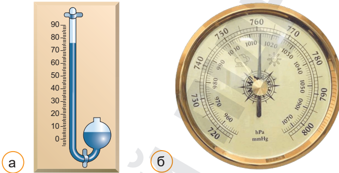
Мал. 2. Барометри: а – ртутний барометр; б – барометр-анероїд
