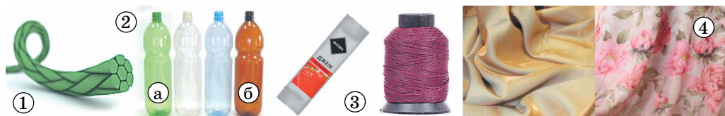
Рис. 28.4. 1. Лавсанові нитки – хірургічний шовний матеріал, що не розсмоктується. 2. Упаковка: а) для напоїв (ПЕТ); б) для харчів (композиція лавсану й алюмінієвої фольги). 3. Плетений лавсановий шнур. 4. Лавсанові тканини
