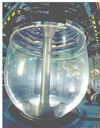
Рис. 29.2. Видувне формування поліетилену
