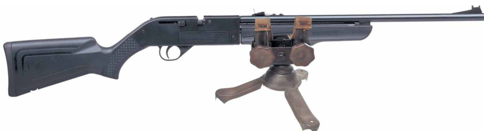
Мал. 13. Гвинтівка, закріплена у прицільному верстаті ПС-51
