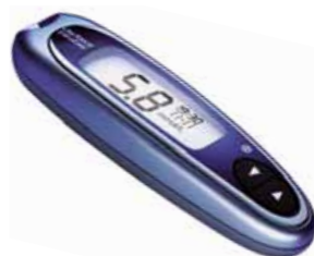
Рис. 24. Глюкометр: прибор для измерения уровня глюкозы в крови
