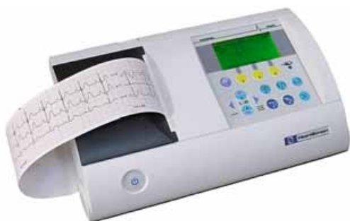
Рис. 26. Электрокардиограф и полученные с его помощью показатели деятельности сердца (электрокардиограмма)
