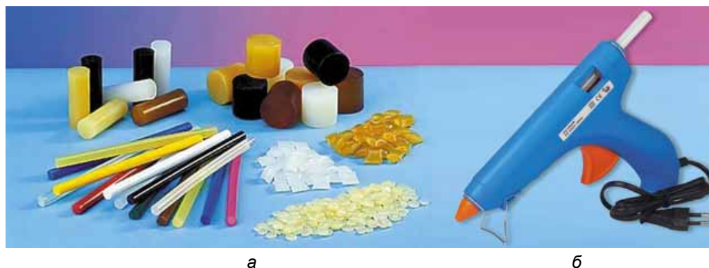
Мал. 54. Патрони термоклею (а); термопістолет (б)
