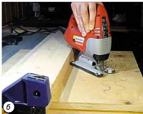
Мал. 44. Вирізування криволінійних поверхонь лобзиком: а – ручним; б – електричним
