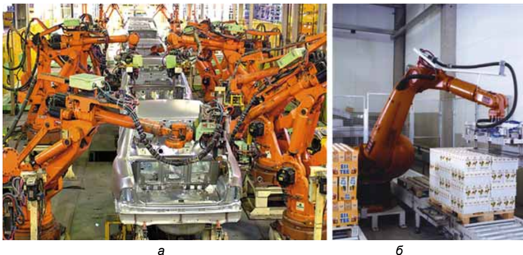
Мал. 88. Автоматичні лінії із застосуванням робота: а – у машинобудівній промисловості; б – у харчовій промисловості
