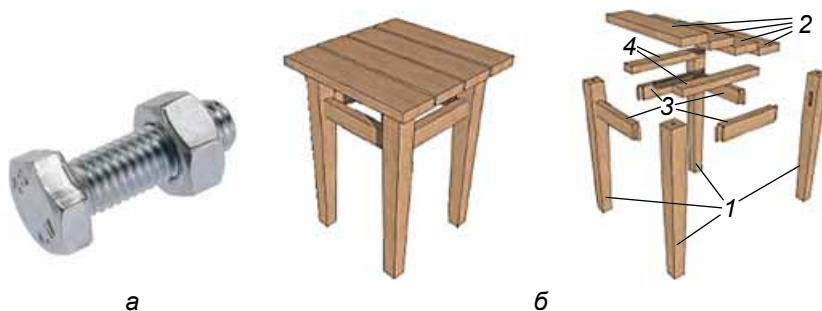
Мал. 29. Складальна одиниця: а – болтове з'єднання; б – табурет
