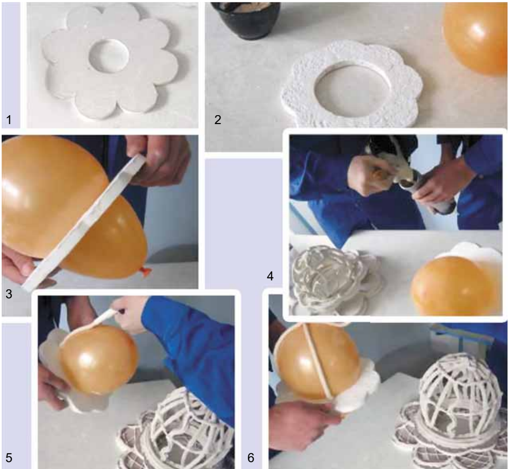
Мал. 192. Послідовність виготовлення світильника з використанням повітряних кульок
