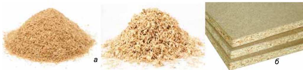
Мал. 20. Деревостружкова плита: а – матеріал для ДСП (тирса, стружка); б – плита
