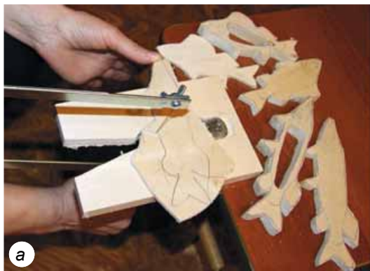
Мал. 44. Вирізування криволінійних поверхонь лобзиком: а – ручним; б – електричним
